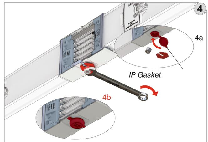
Apriete el perno principal hasta que se rompa la primera tuerca. (4a) Coloque el empaque IP en el orificio de la union. Si por alguna razón se va a interferir con la fijación del bloque, después de este proceso, apriete el perno del inserto del bloque en 20 Nm con una llave dinamométrica (4b).
