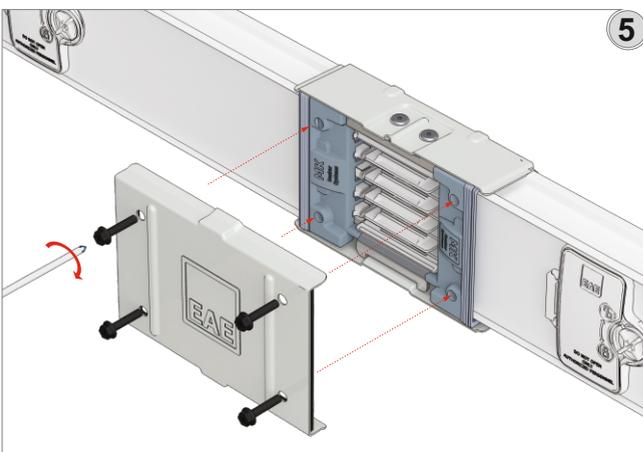
Instale la placa de cubierta lateral adicional.
