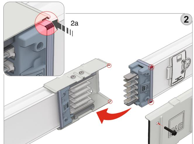
Alinee dos barras colectoras como la imagen-2a e inserte los conductores de la barra colectoras en la unión del bloque.
